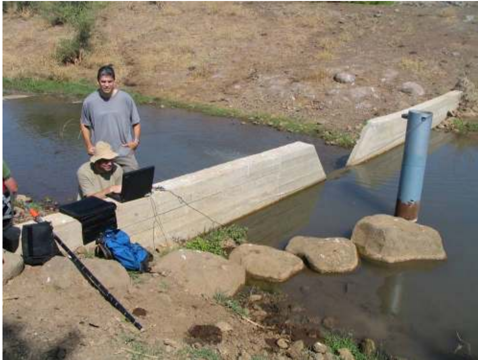
תמונה 4 : הורדת נתונים ממד המפלס בתעלת הנוחיילה וכיולו.
