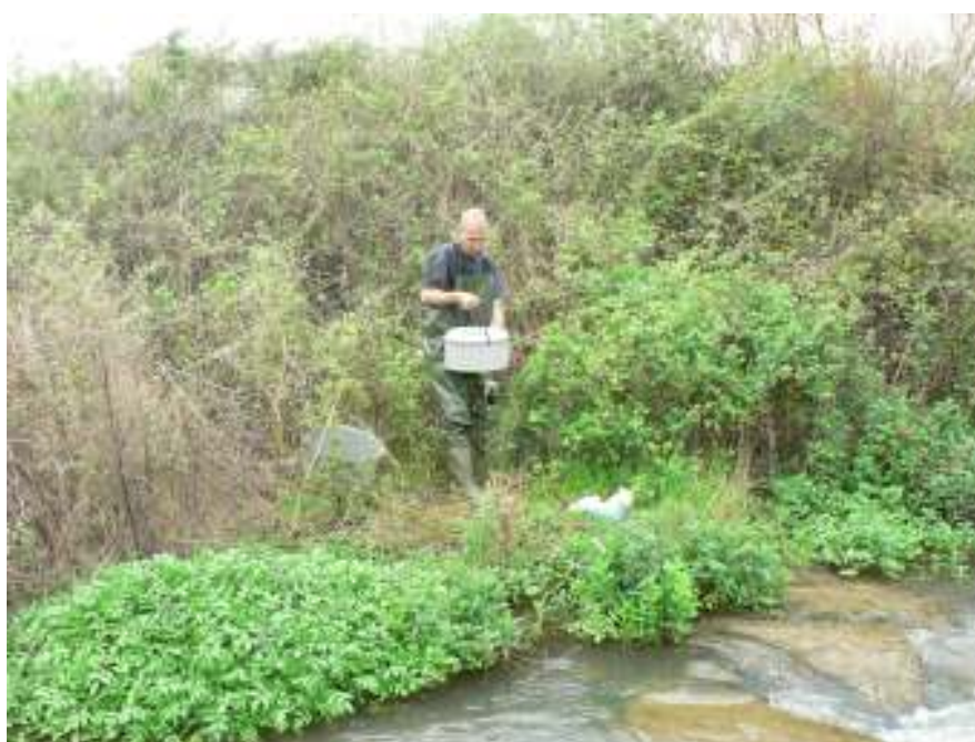
תמונה 7 : התקנת דוגם אוטומטי בתחנה B בעת ניסוי החורף – 6/3/2008.
