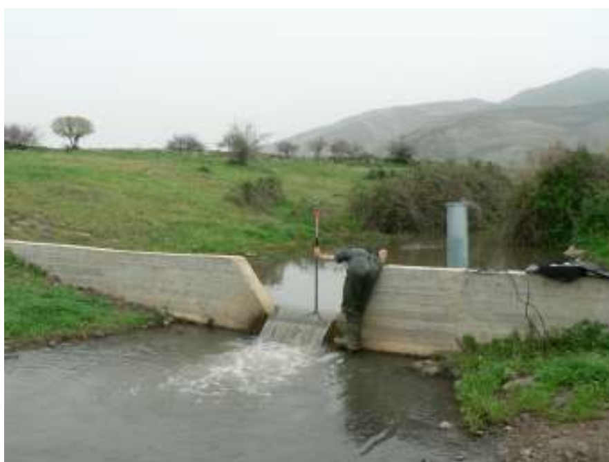
תמונה 5 : מדידת ספיקה לכיול סכרון המדידה בעת הניסוי החורפי ב 6/3/2008.
